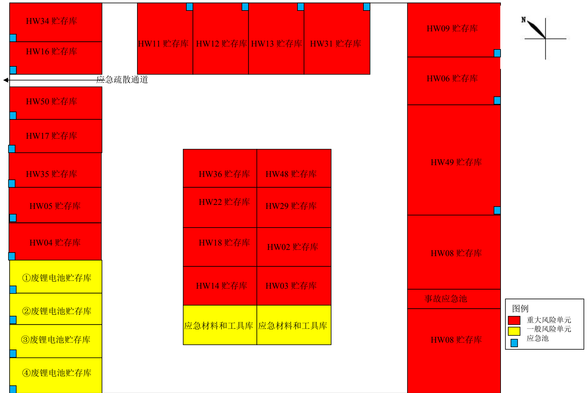
附图 3 危险单元分布、应急疏散通道、防止事故水进入外环境的控制封堵系统图
