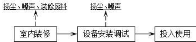
图 2-2 建设项目施工期建设工艺流程及产污环节示意图
