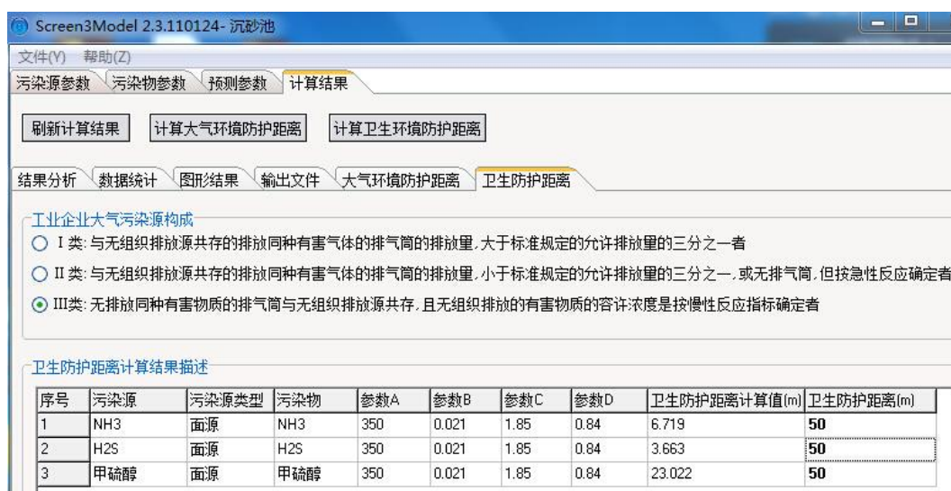
图 3.4-1 沉砂池卫生环境防护距离计算过程图
