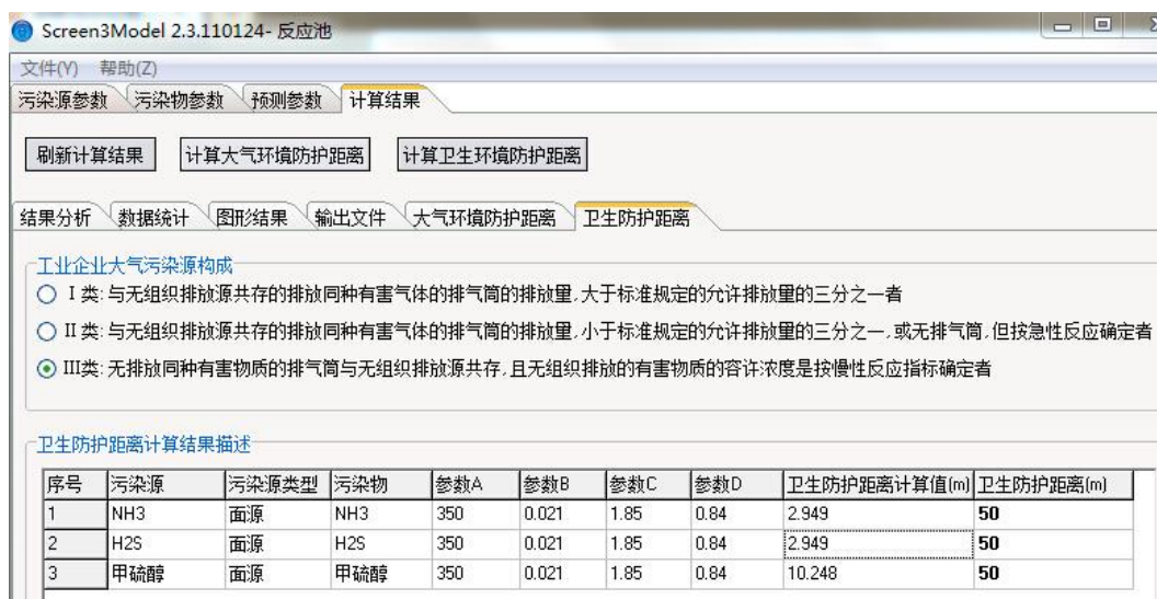
图 3.4-2 反应池卫生环境防护距离计算过程图
