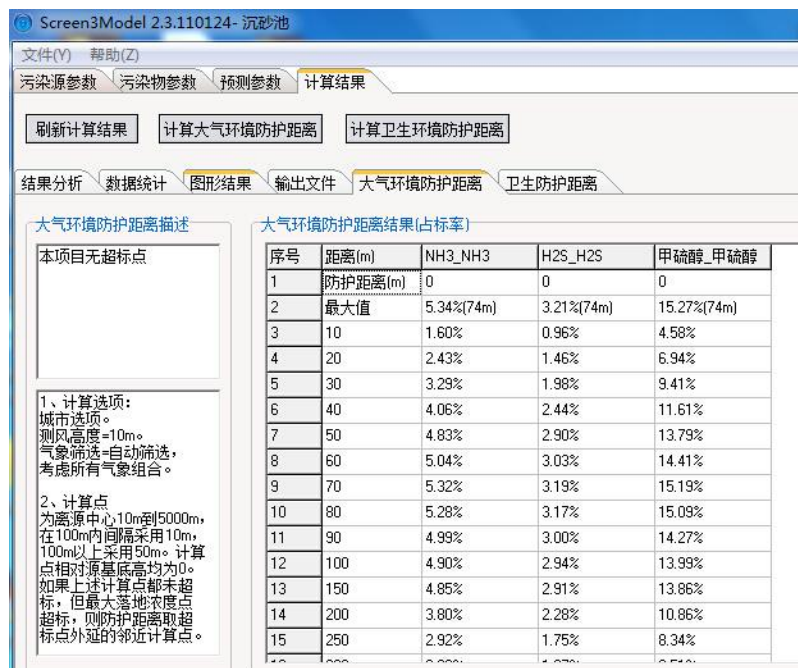
图 3.3-1 沉砂池大气环境保护距离计算过程图
