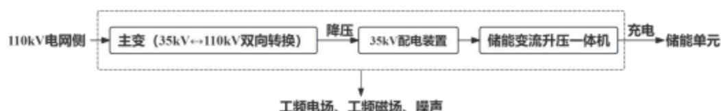
图 4-2 储能电站充电模式工艺流程及产污节点图
