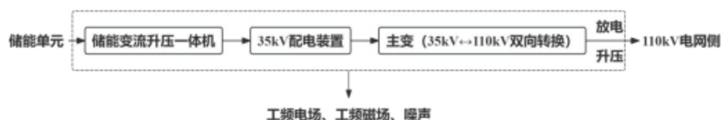
图 4-3 储能电站放电模式工艺流程及产污节点图
