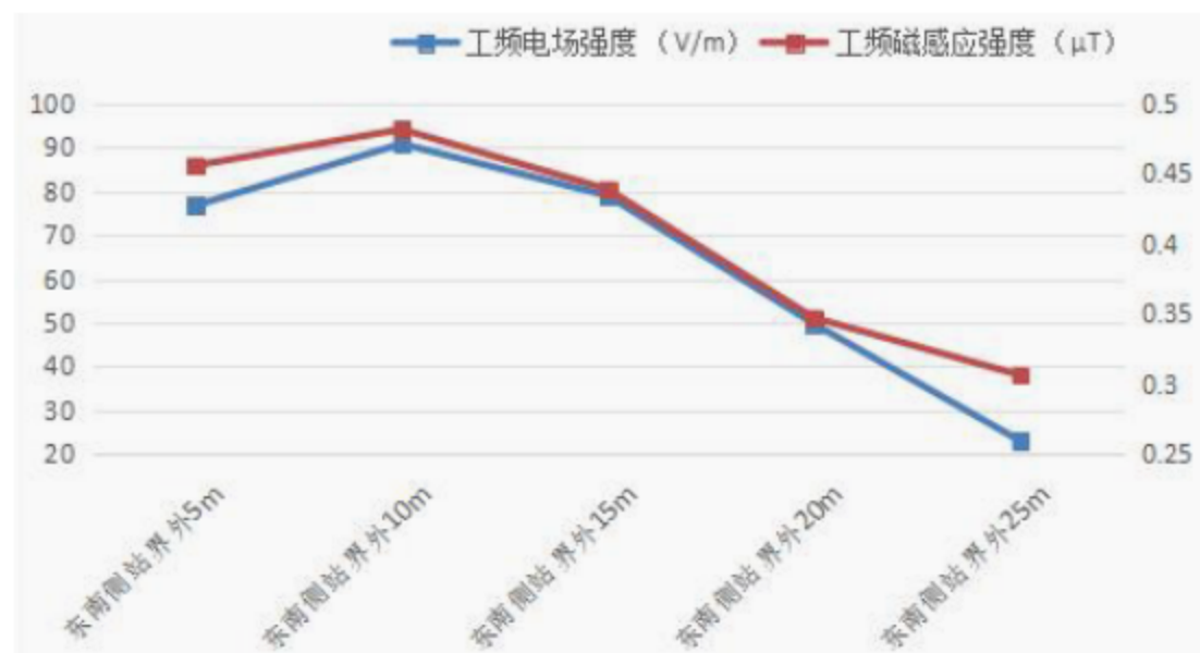
图 3.4-1 类比储能电站围墙外工频电磁场随距离变化趋势图
