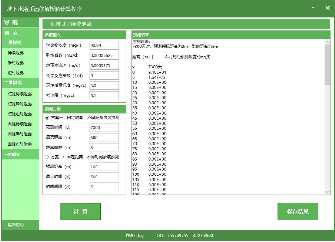
图 6.2-2：CODMn 渗漏时间和位置变化的迁移结果
