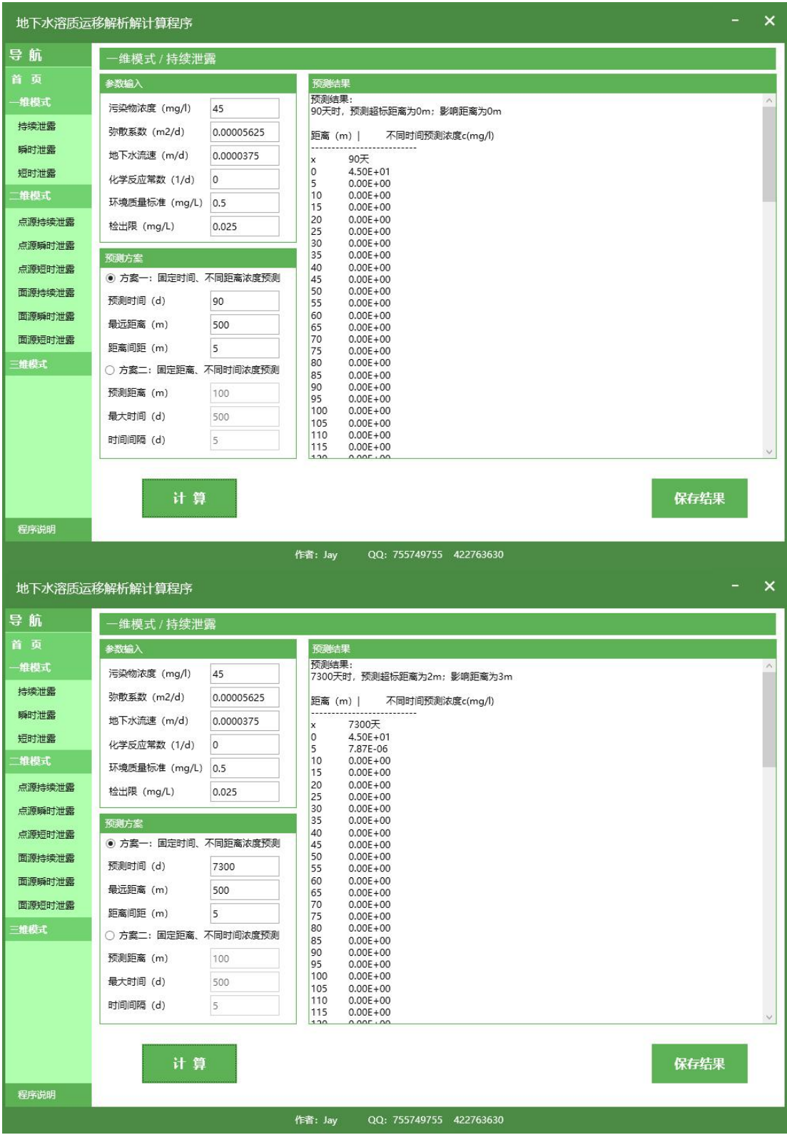
图 6.2-3：NH 3 -N 渗漏时间和位置变化的迁移结果
