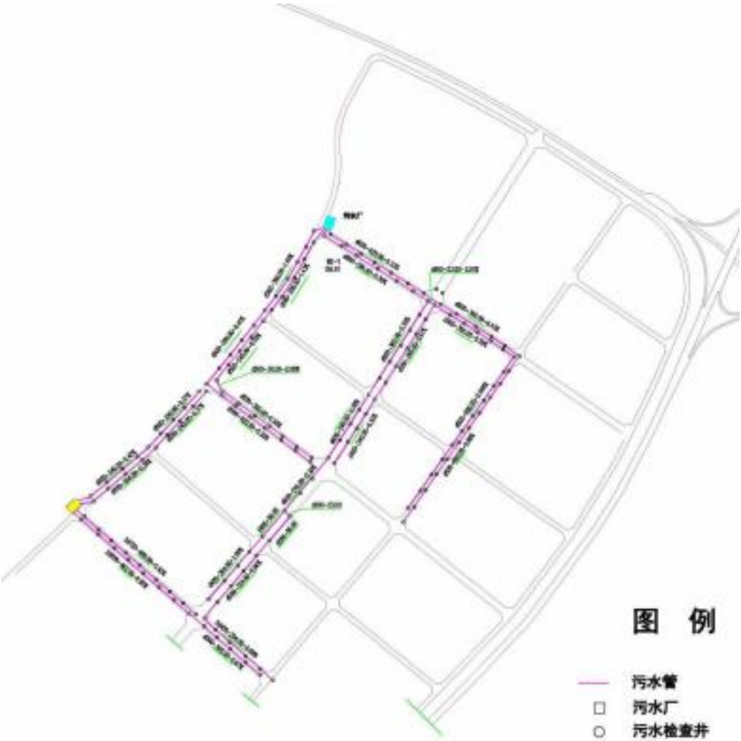
图 3.1-1 园区污水管网现状图
