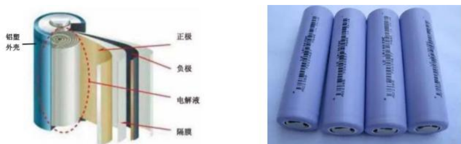
圆柱形锂电池单体结构图与实体图
