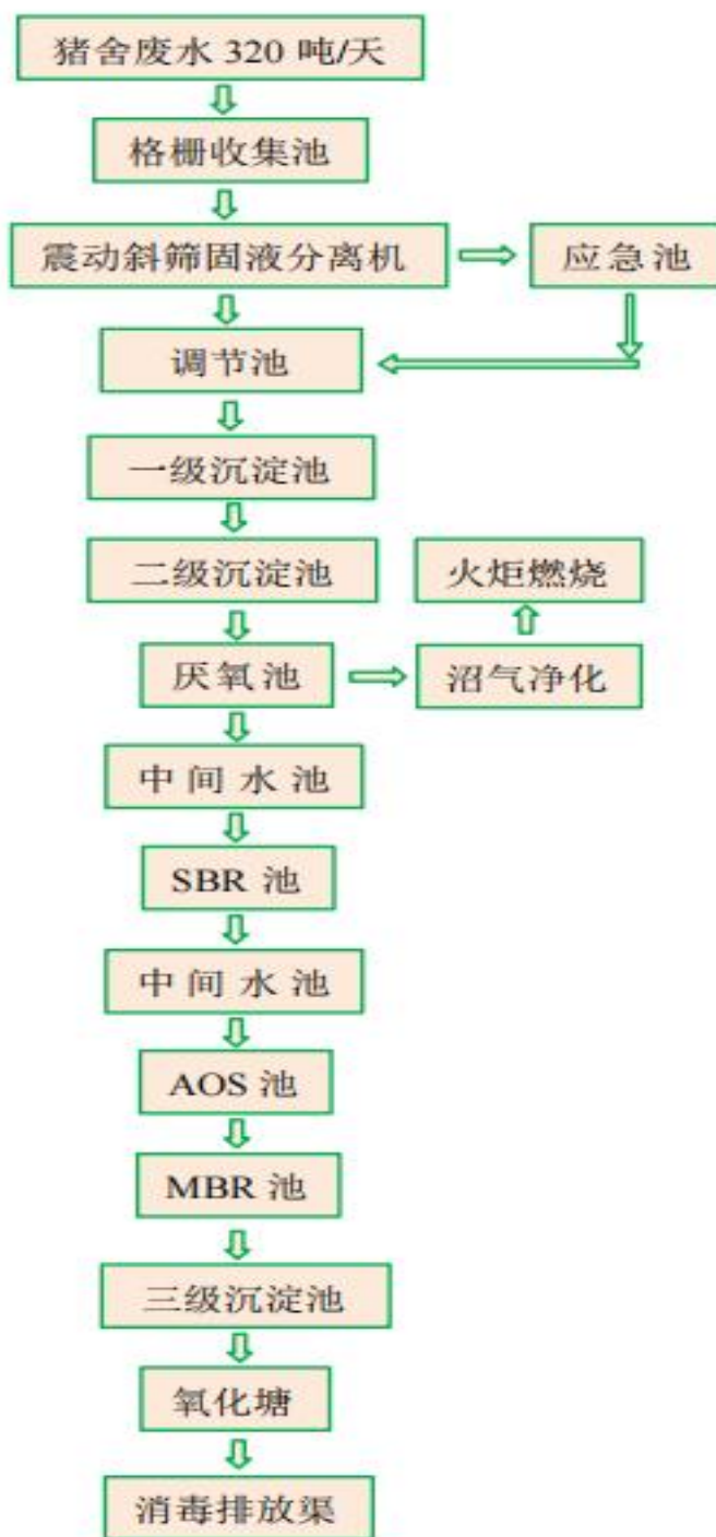
图 2.3-4 猪粪与污水处理工艺流程图
