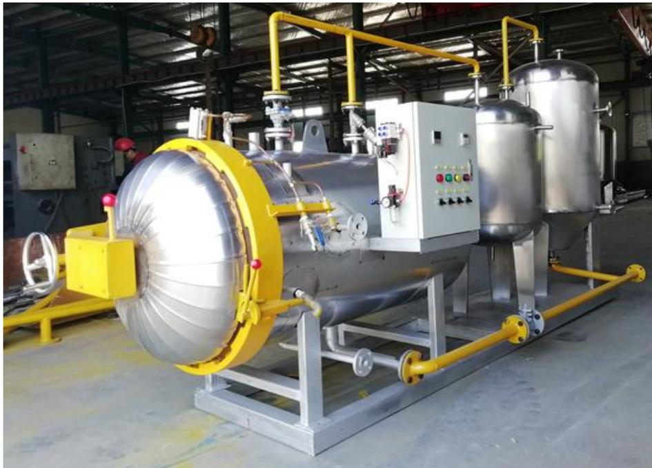
图3-7 湿法化制成套设备
