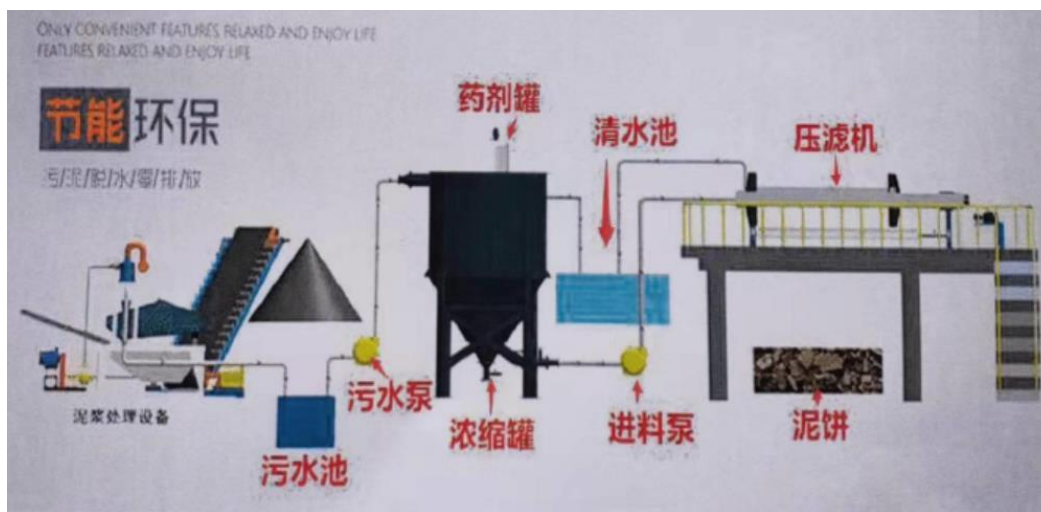
图 7-1 本项目污水处理站工艺流程示意图
