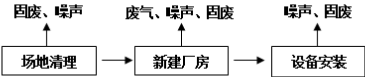
图 5-1 施工期工艺流程及产污节点图
