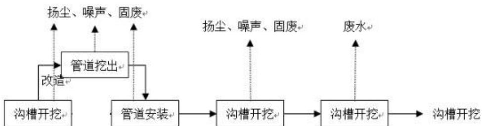
图 5-3 施工期工艺流程图（改造管网工程）
