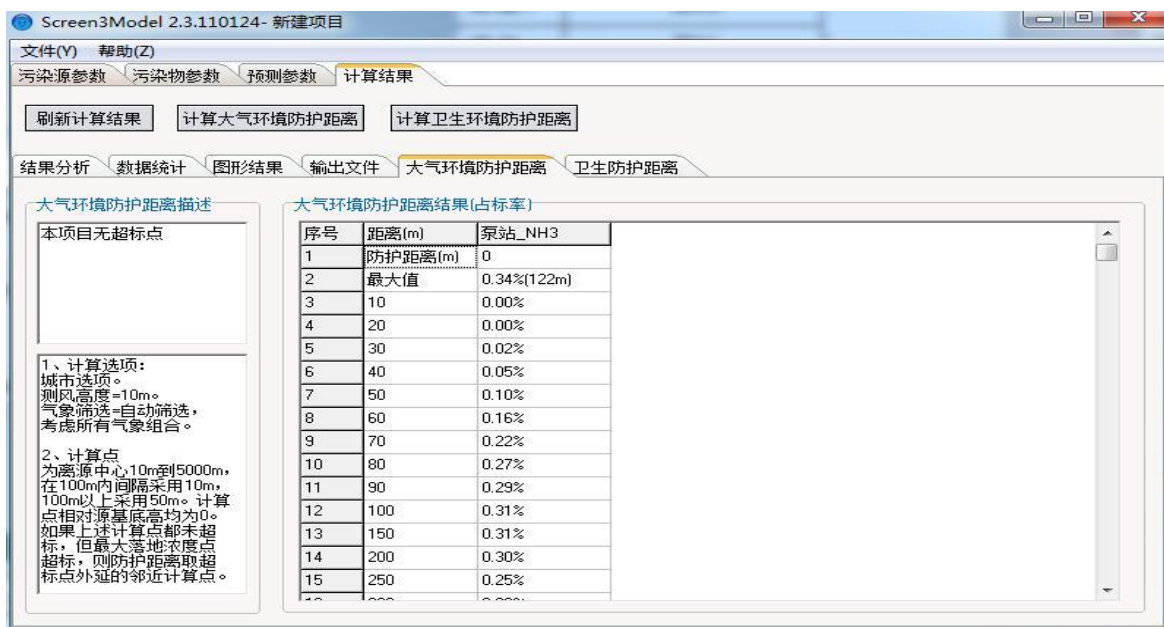
图 7-1 硫化氢大气防护距离计算结果
